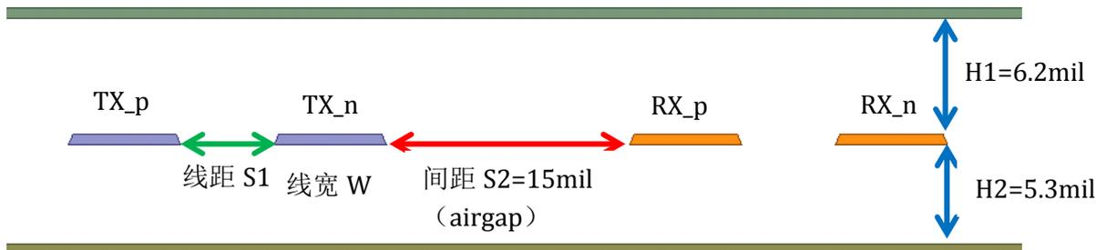
在上图所示的结构中，TX、RX 同层布线，差分线的线宽/线距一样， $W/S1=6\text{mil}/9\text{mil}$ ，当 TX、RX 之间的线间距 S2 没有按照 3W 或 5H 的线间距做，而是小于 3W 时（仿真用
